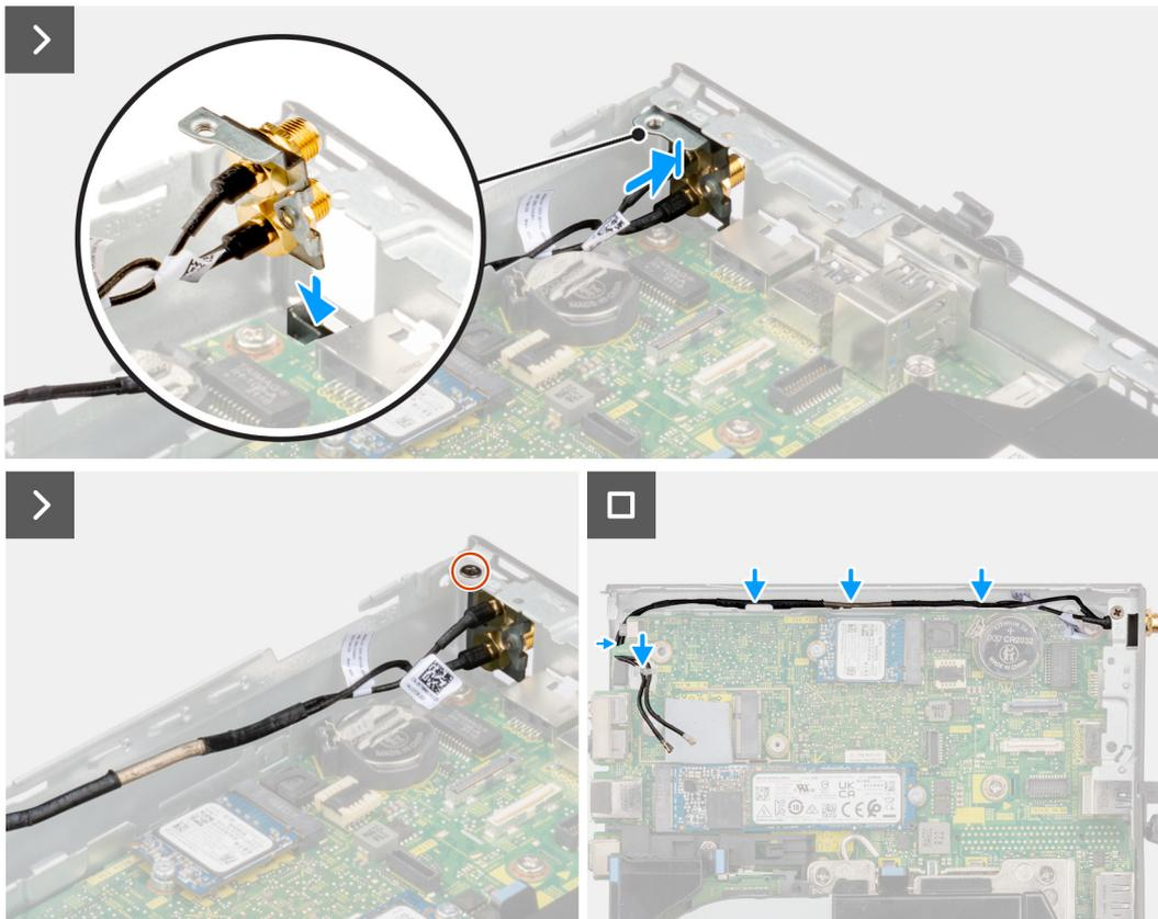
**Ilustración 55. Instalación de la antena de SMA (ubicación 3)**
