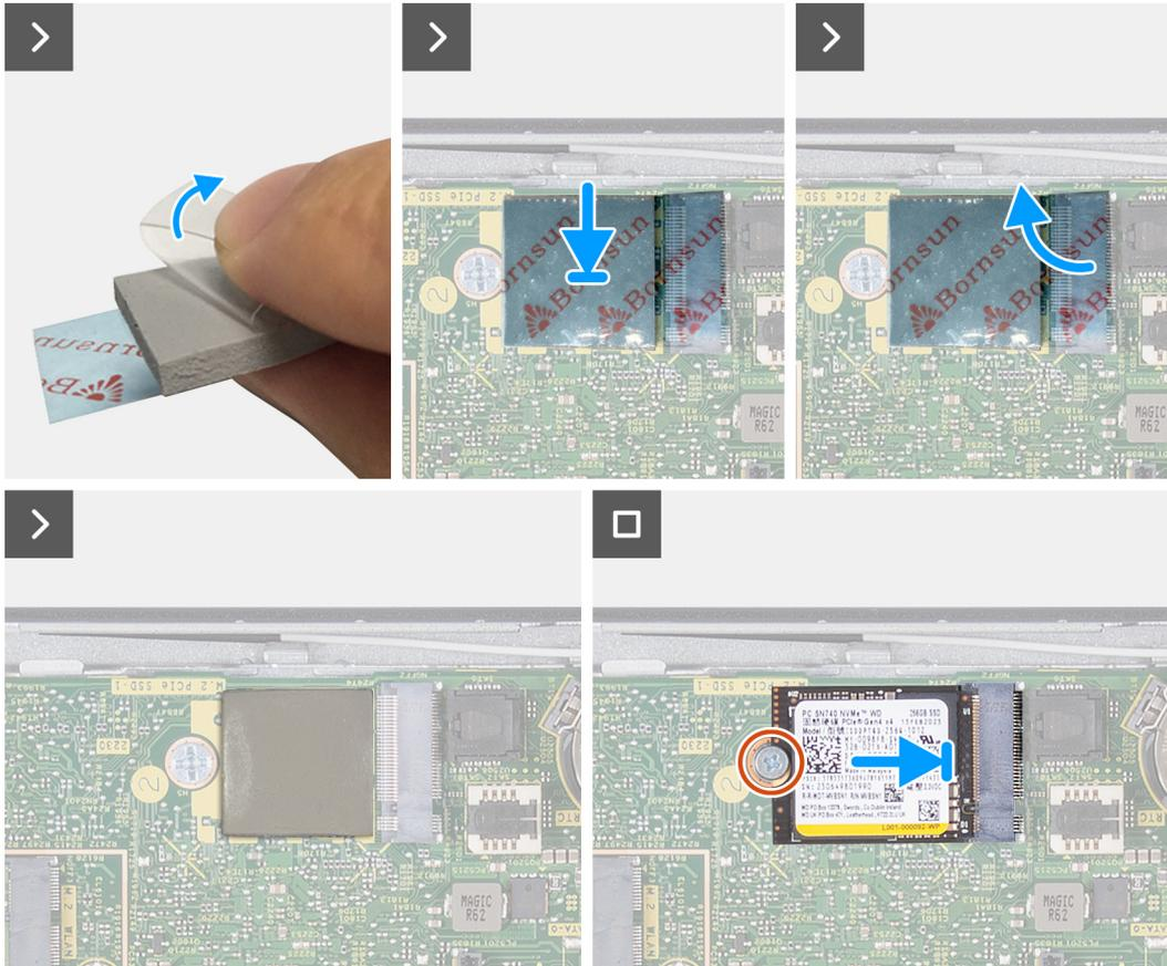
**Ilustración 24. Instalación de la unidad de estado sólido M.2 2230 en la ranura 1**
