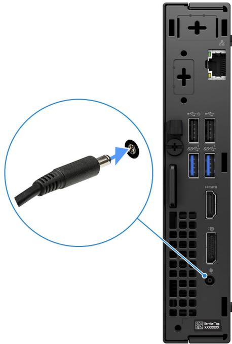
**Ilustración 6. Conecte el cable de alimentación.**
