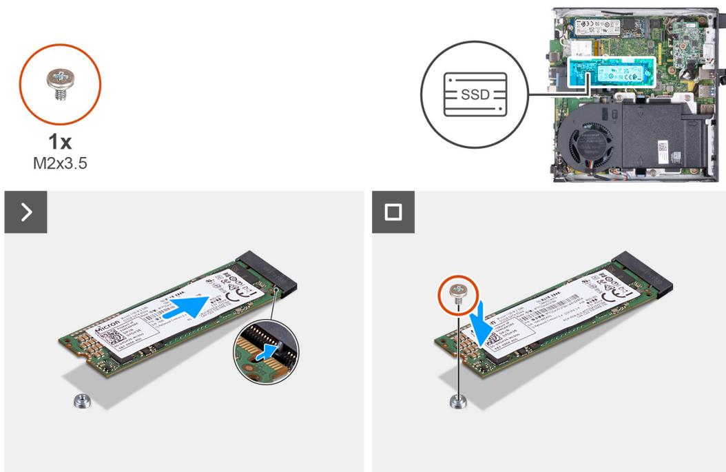
**Ilustración 22. Instalación de la unidad de estado sólido M.2 2280 en la ranura 0**
