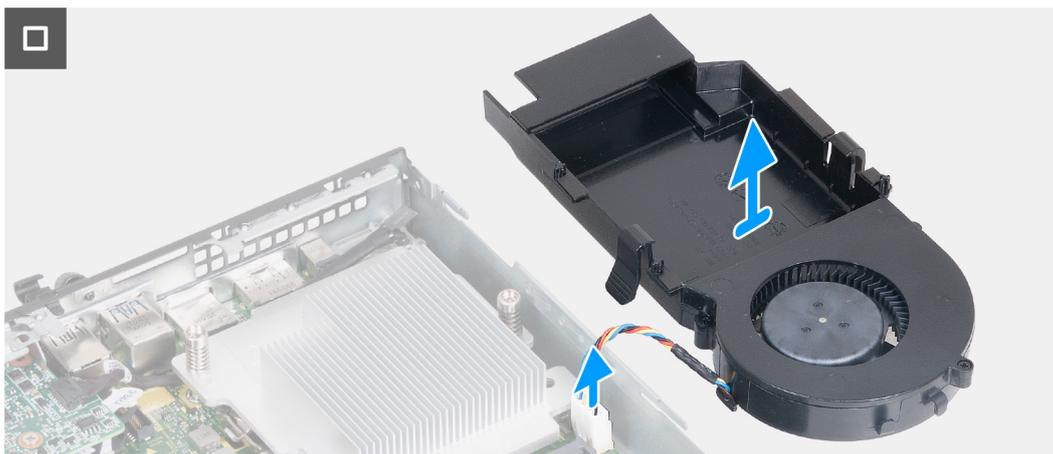
**Ilustración 30. Extracción del ventilador**
