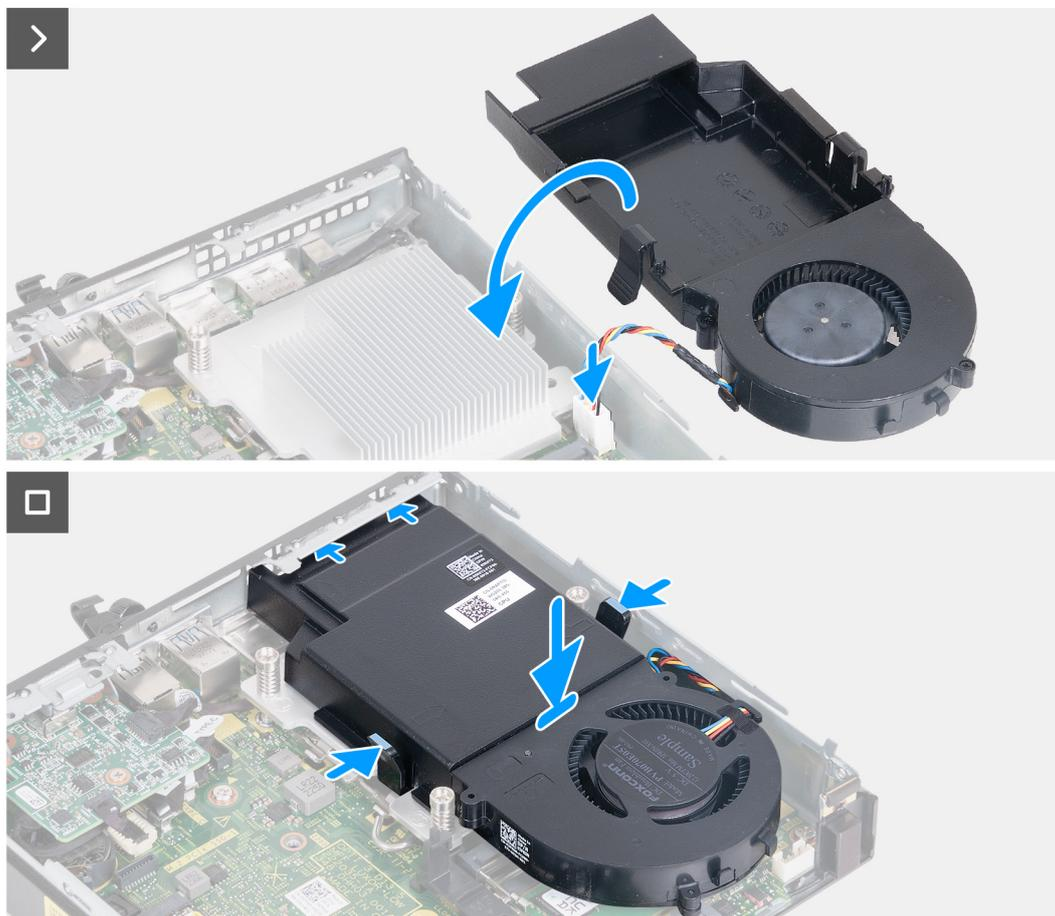
**Ilustración 31. Instalación del ventilador**
