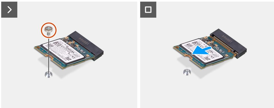
**Ilustración 23. Extracción de la unidad de estado sólido M.2 2230 de la ranura 1**
