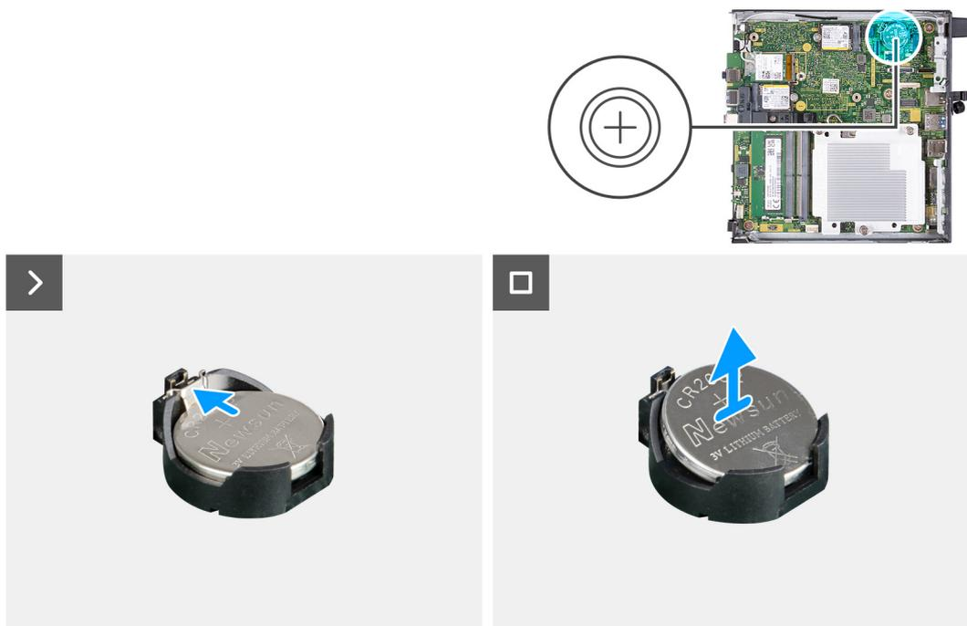
**Ilustración 13. Extracción de la batería de tipo botón**
