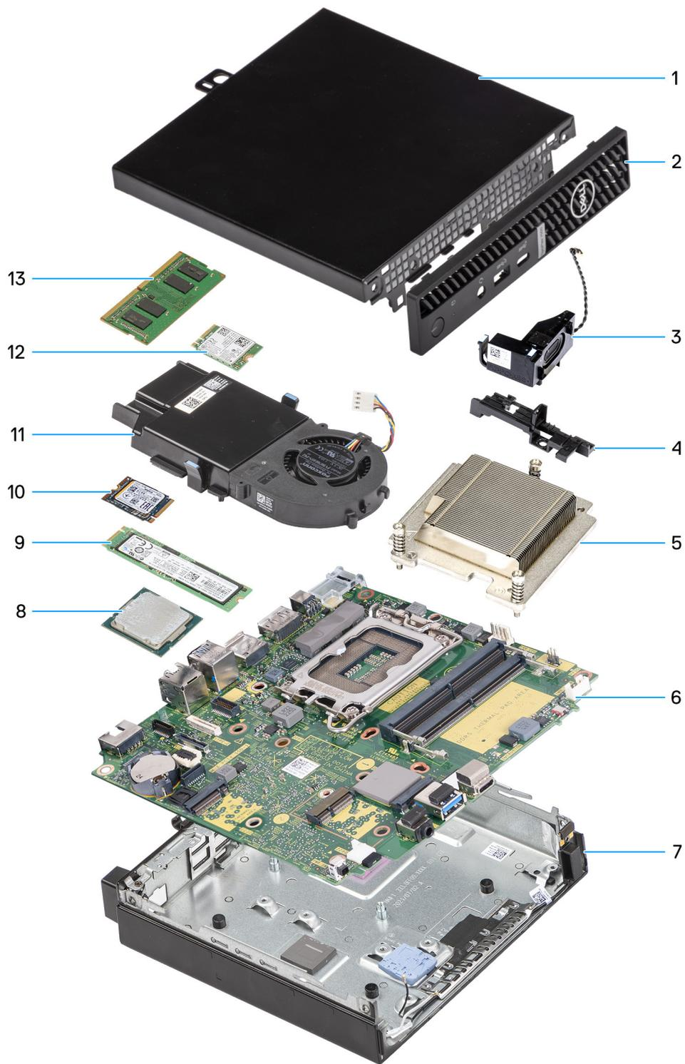
**Ilustración 8. Componentes principales de la OptiPlex Micro 7020**
