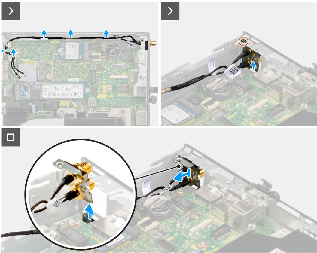
**Ilustración 54. Extracción de la antena de SMA (ubicación 3)**
