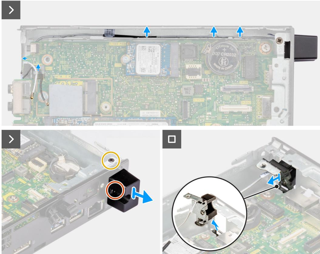
**Ilustración 50. Extracción del módulo de la antena (cable blanco)**
