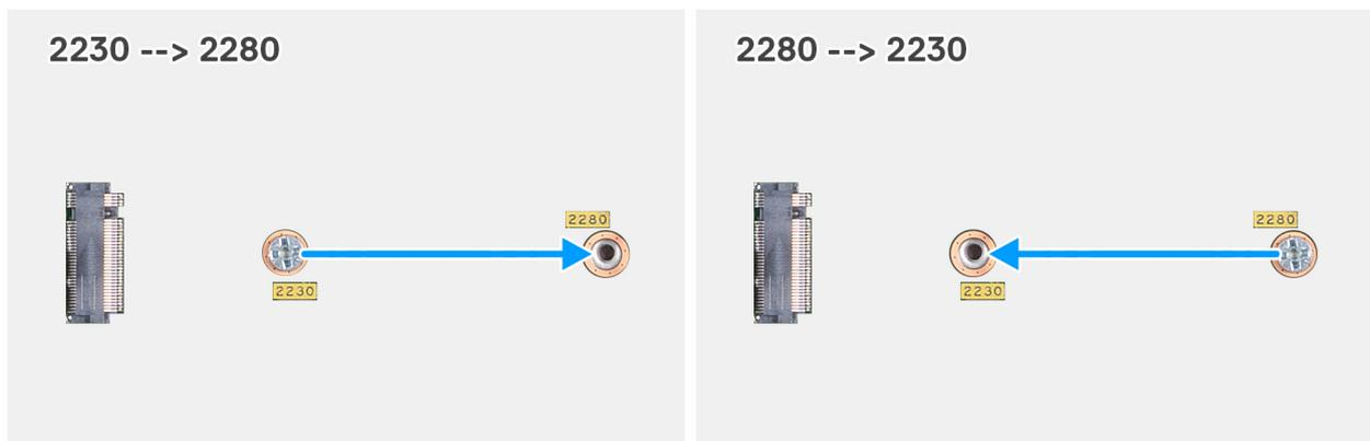
**Ilustración 27. Movimiento del montaje de tornillos para admitir un factor de forma diferente (OptiPlex Micro 7020)**
