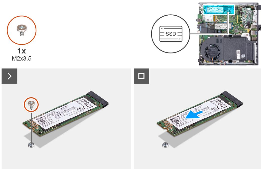
**Ilustración 25. Extracción de la unidad de estado sólido M.2 2280 de la ranura 1**
