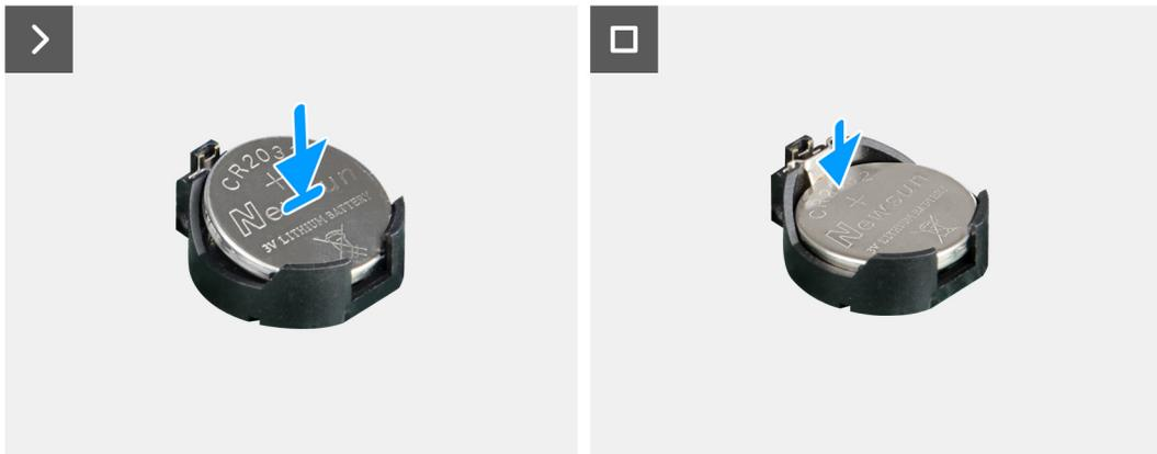
**Ilustración 14.** Instalación de la batería de tipo botón
