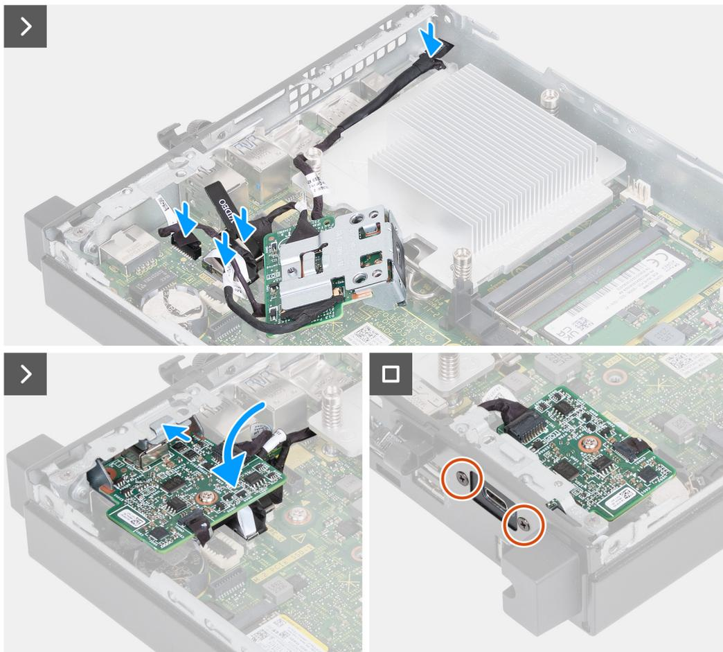
**Ilustración 39. Instalación del módulo Type-C opcional**
