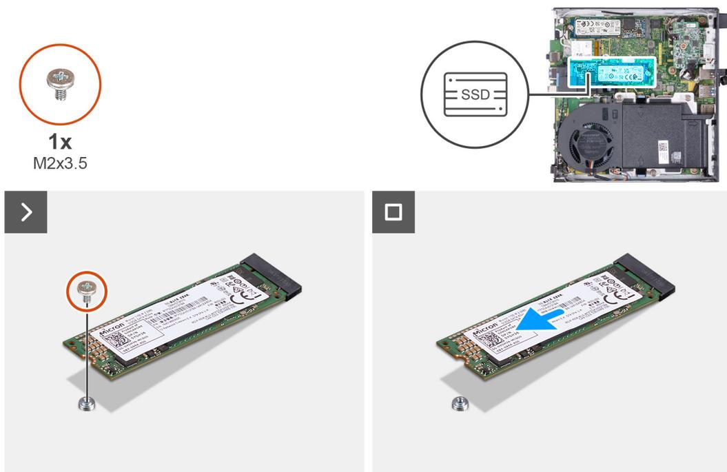
**Ilustración 21. Extracción de la unidad de estado sólido M.2 2280 de la ranura 0**
